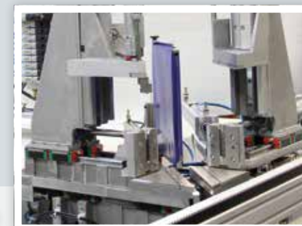
Changement des contre-formes sans outil Cambio de contraformas sin herramientas
