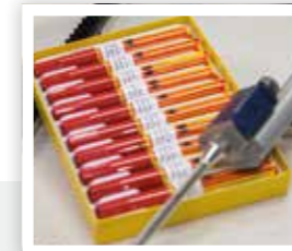
Automatisches Lackieren der Nut nach dem Verputzen optional möglich Automatic groove colouring after cleaning
