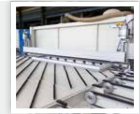
integrierte Stulpsäge in-line faceplate saw
