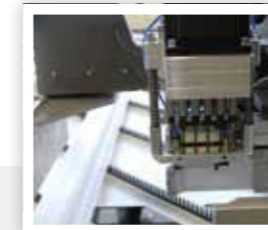
Eck- und Scherenlagerbohren hinge drilling
