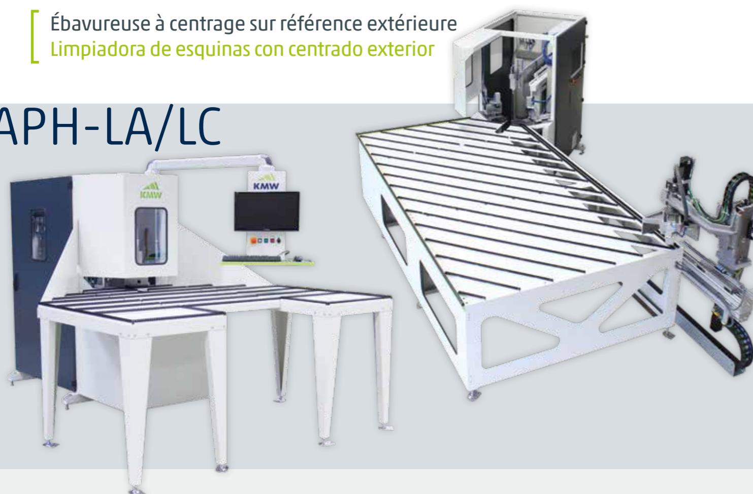
Ébavureuse CNC à haute vitesse d'exécution et de précision, équipée de la dernière technologie de moteur linéaire
