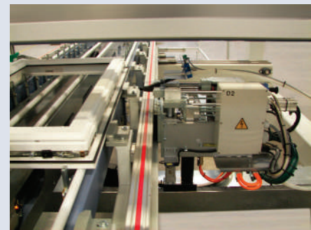
NC-gesteuerter Schrauber in Austransporttrichtung
